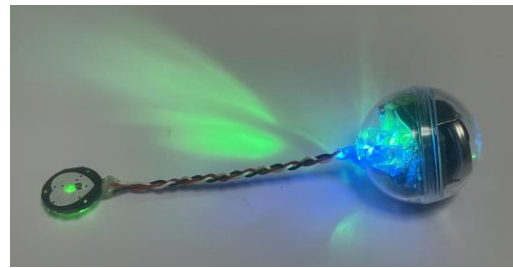
図 9.2 φ30mm のケースに入って動作した試作品
